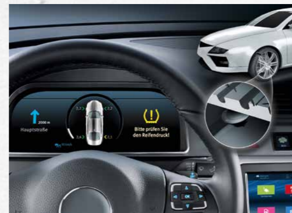
Funktionsweise des direkten Systems
